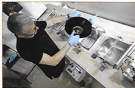
**Les disques passent au rinçage après un nettoyage profond dans une cuve ultrasonique.**
